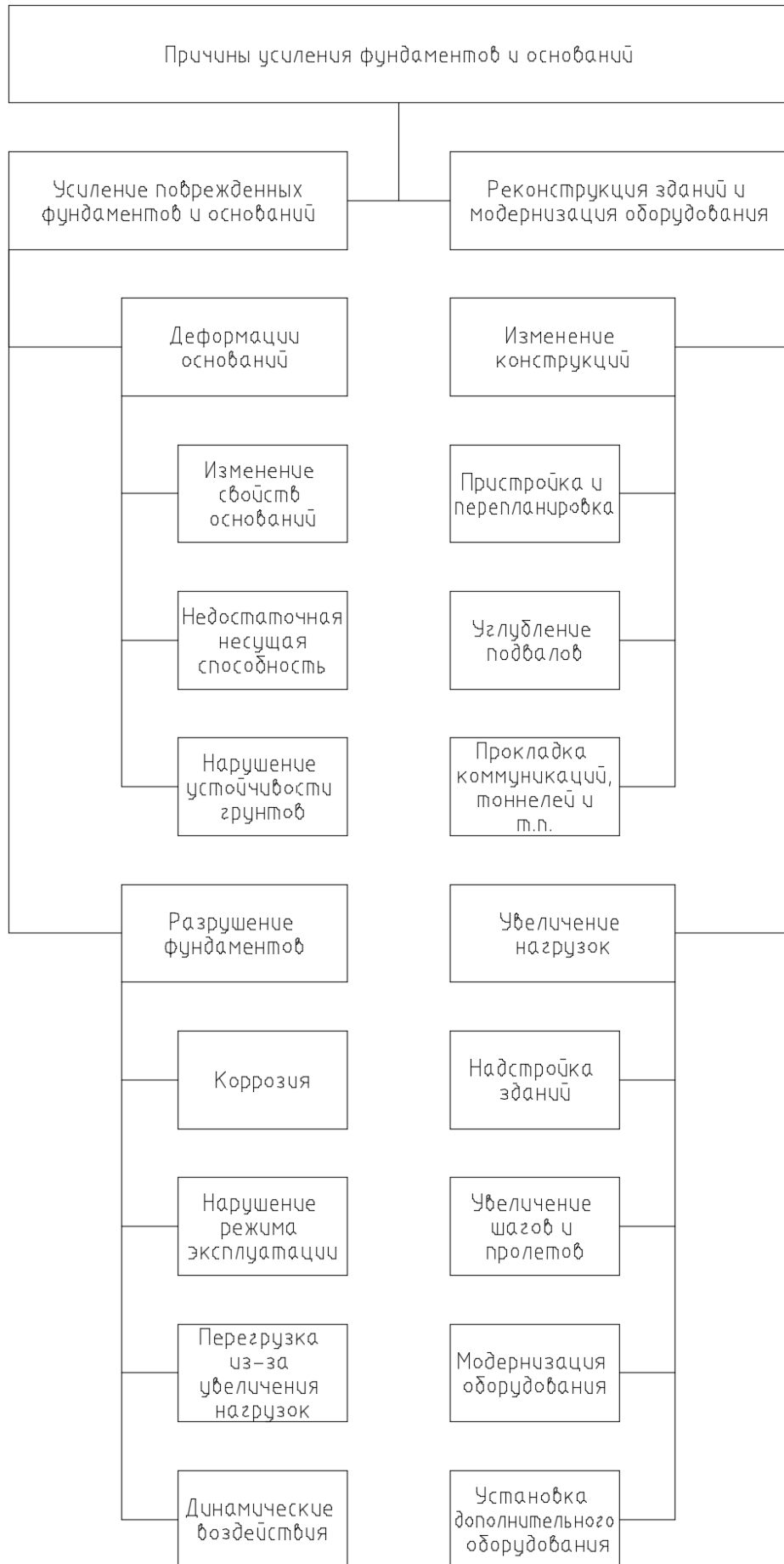
Рисунок 1. Классификация причин укрепления грунтовых оснований
